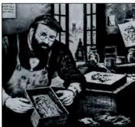
Der Franzose Gillot entwickelt 1867 die Zinkotypie, das Prinzip der Strichätzung. Links eine Zinkotypie mit dem Portrait Gutenbergs.
