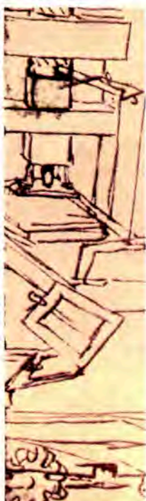
Leonardo da Vinci beschäftigte sich ebenfalls mit der Konstruktion einer Druckmaschine. Die Skizze lässt erkennen, dass Leonardo bereits an einen halbautomatischen Vorschub des Fundamentes dachte.
