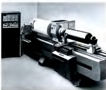
Der Klischograph von Hell gilt als Vorgänger der Trommelscanner und rationalisierte die Klischeeherstellung.
