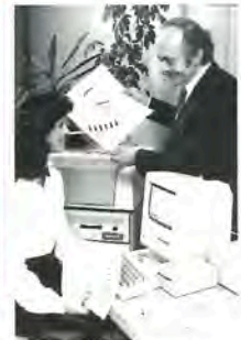
Die Drupa 1951 ist für die Druckindustrie ebenso Geschichte wie die ersten Schritte im Publishing. Im Bild der »Ur-Mac«, im Hintergrund die Linotronic, die als erster Laserbelichter von der Seitenbeschreibungssprache PostScript angesteuert werden konnte.
